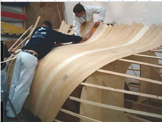
Na especialidade de construción naval trabállase primeiro con madeira (para facer o modelo do que sairá o molde), polo que tamén se adquiren competencias propias da carpintaría
